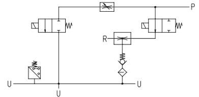
P=CONNESSIONE ARIA COMPRESSA    R=SCARICO    U=CONNESSIONE VUOTO
